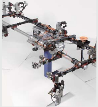
Greifer – Mischbauweise Carbon/Aluminium
