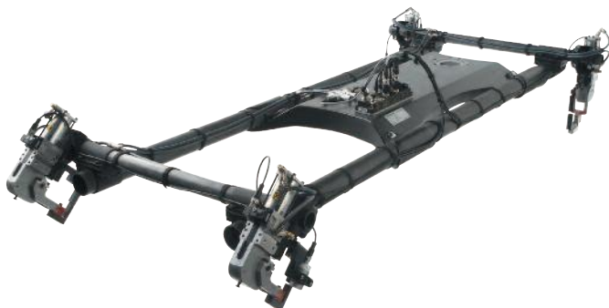
Stingray als Greifersystem – Gesamtgewicht ca. 30 kg
