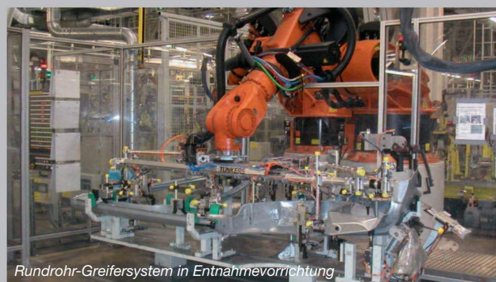
Greifer mit integriertem Falzprozess
