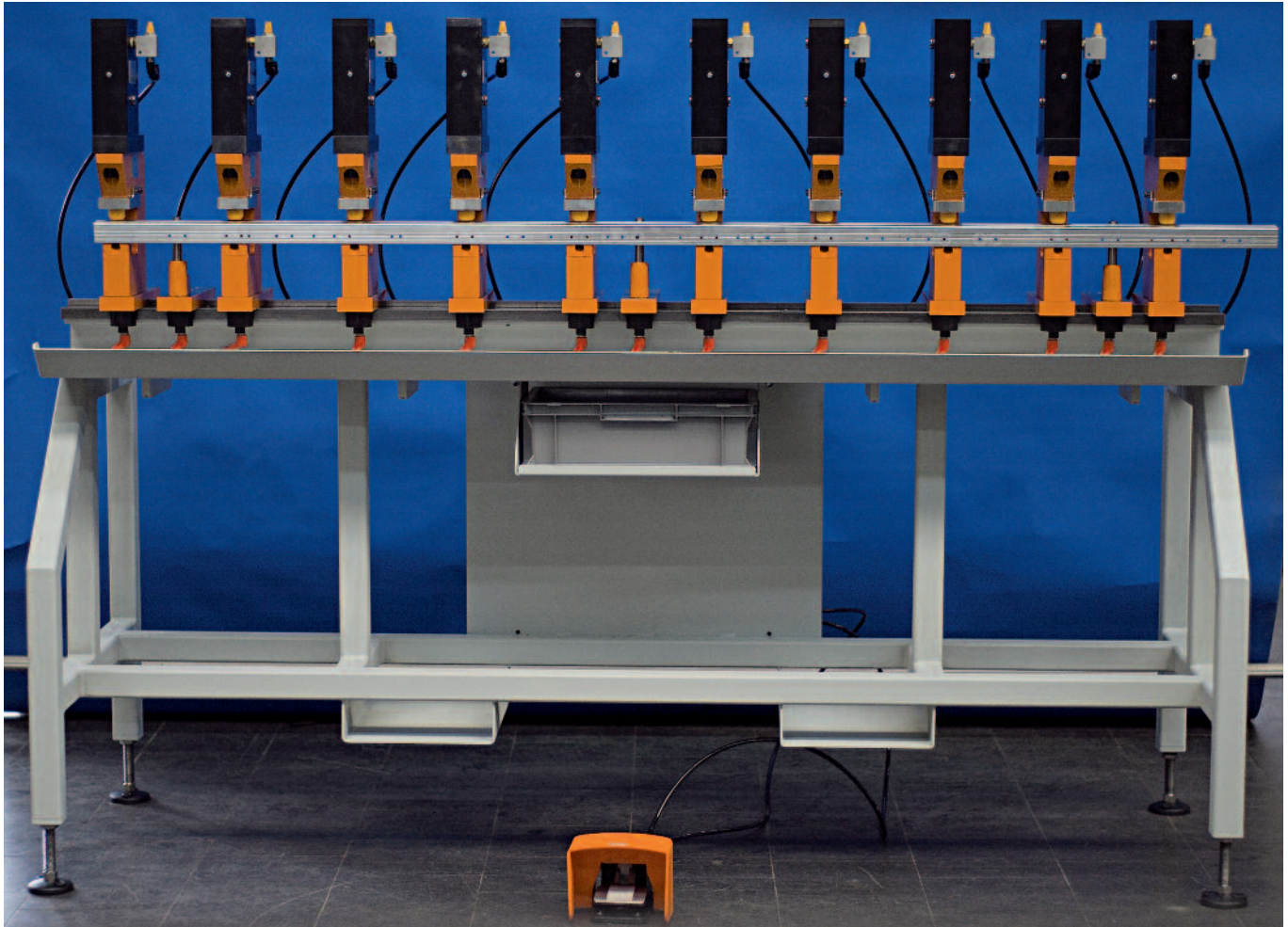
Vorrichtung zum Stanzen von AL-Profilen
