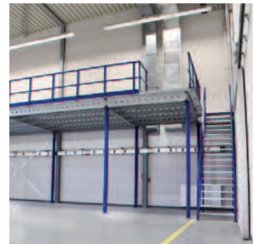
Die IPM-Stahlbau-Bühnen zeichnen sich durch ihre vielfältigen Einsatzmöglichkeiten, ihrer modularen Bauweise und damit durch eine hohe Flexibilität bezüglich Anwendung, Konstruktion und Montage aus. Zum Einsatz kommen spezielle, kaltgewalzte Stahlprofile, die je nach Lastfall durch warmgewalzten Stahlbau ergänzt werden.
